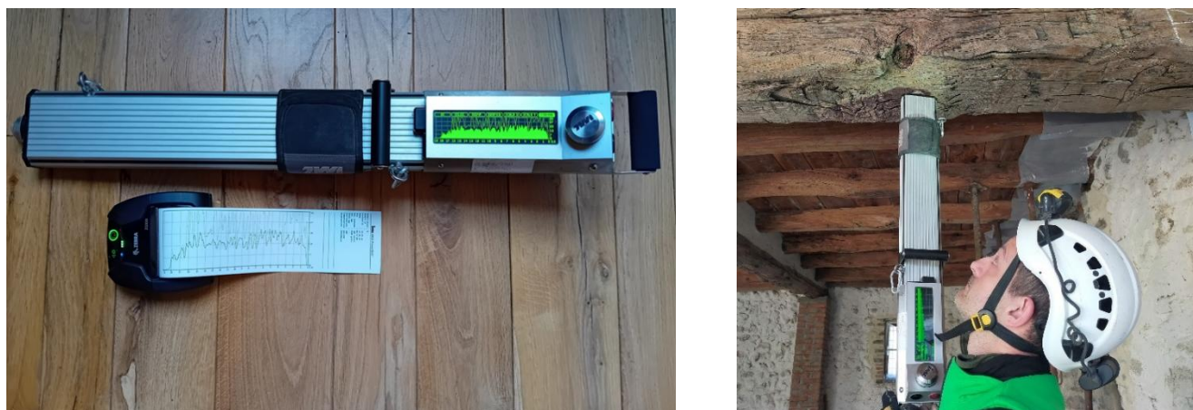
Figura 13. Apparecchio per lo svolgimento delle prove penetrometriche (resistograph).
