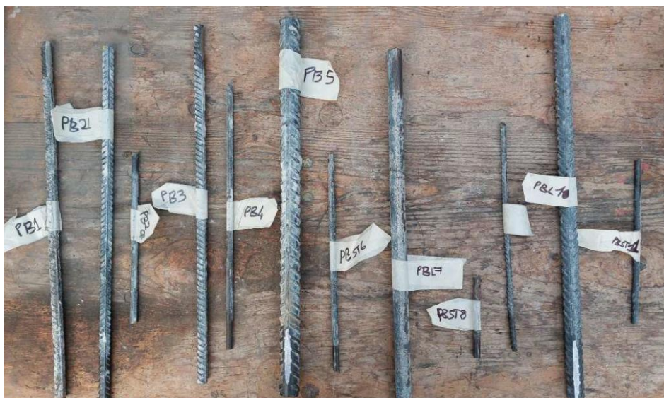
Figura 2. Barre d'armatura prelevate.
