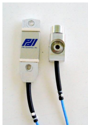
Figura 2. Accelerometro e strain transducer da applicare alla testa del palo.
