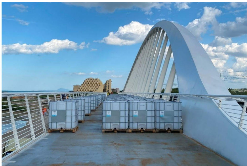
Foto 3. Realizzazione del carico.
