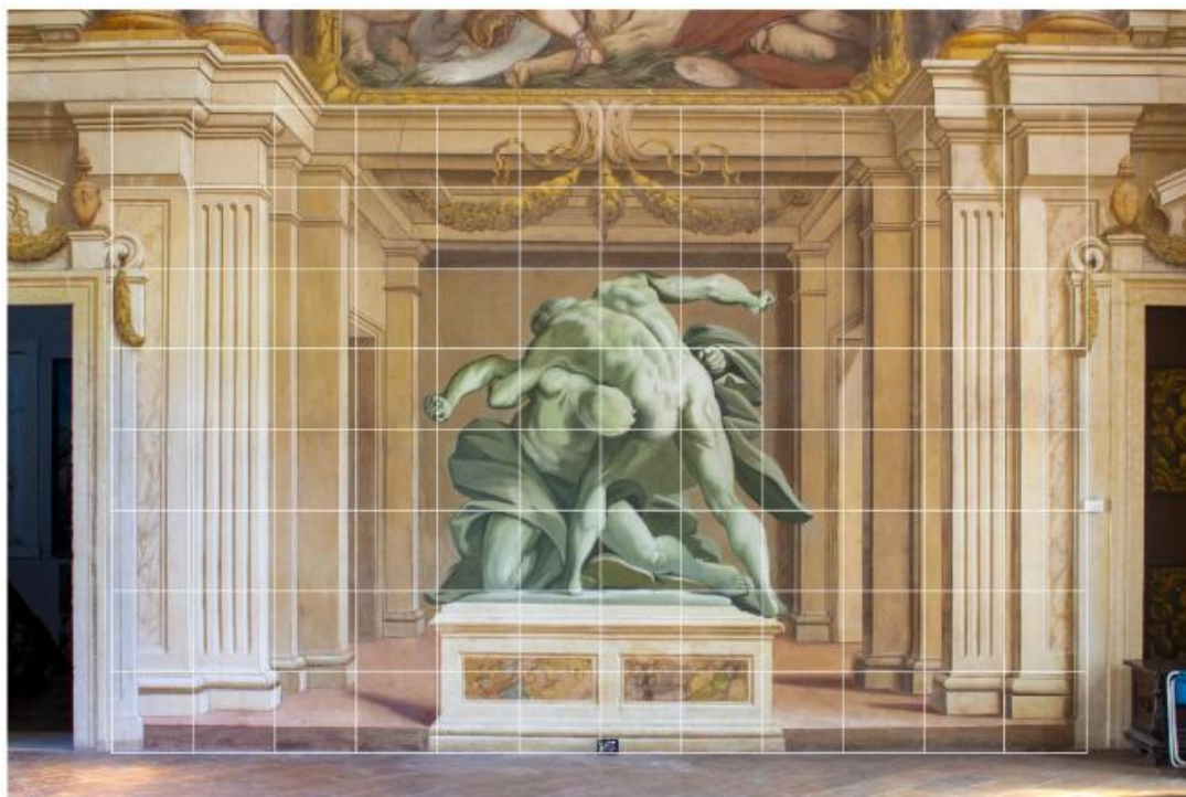
Figura 5. Griglia realizzata per l'esecuzione delle misure ultrasoniche, costituita da 9 righe e 13 colonne (Nimasa Bamunuge Perera, 2023/2024).
