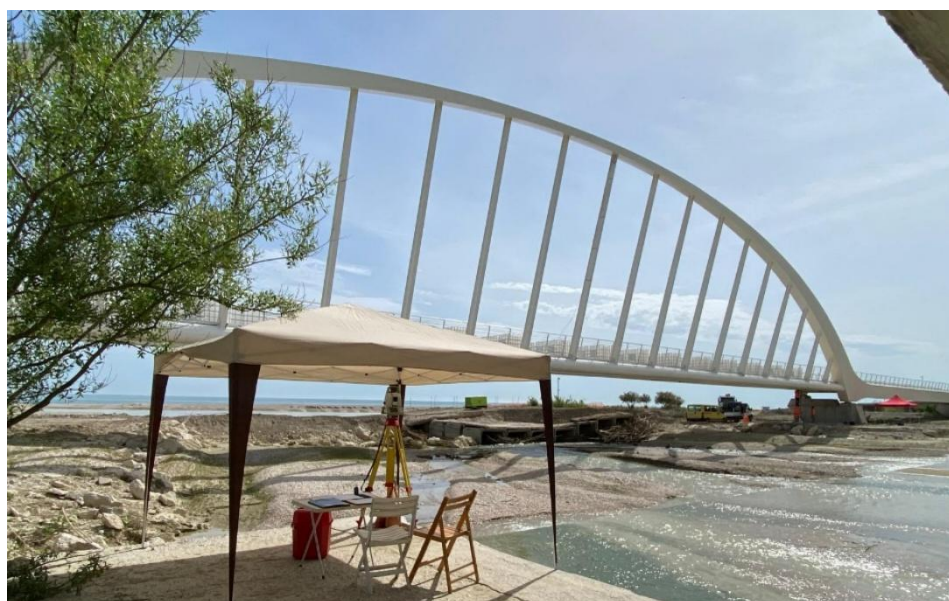
Foto 5. Stazione topografica robotizzata servo-assistita.
