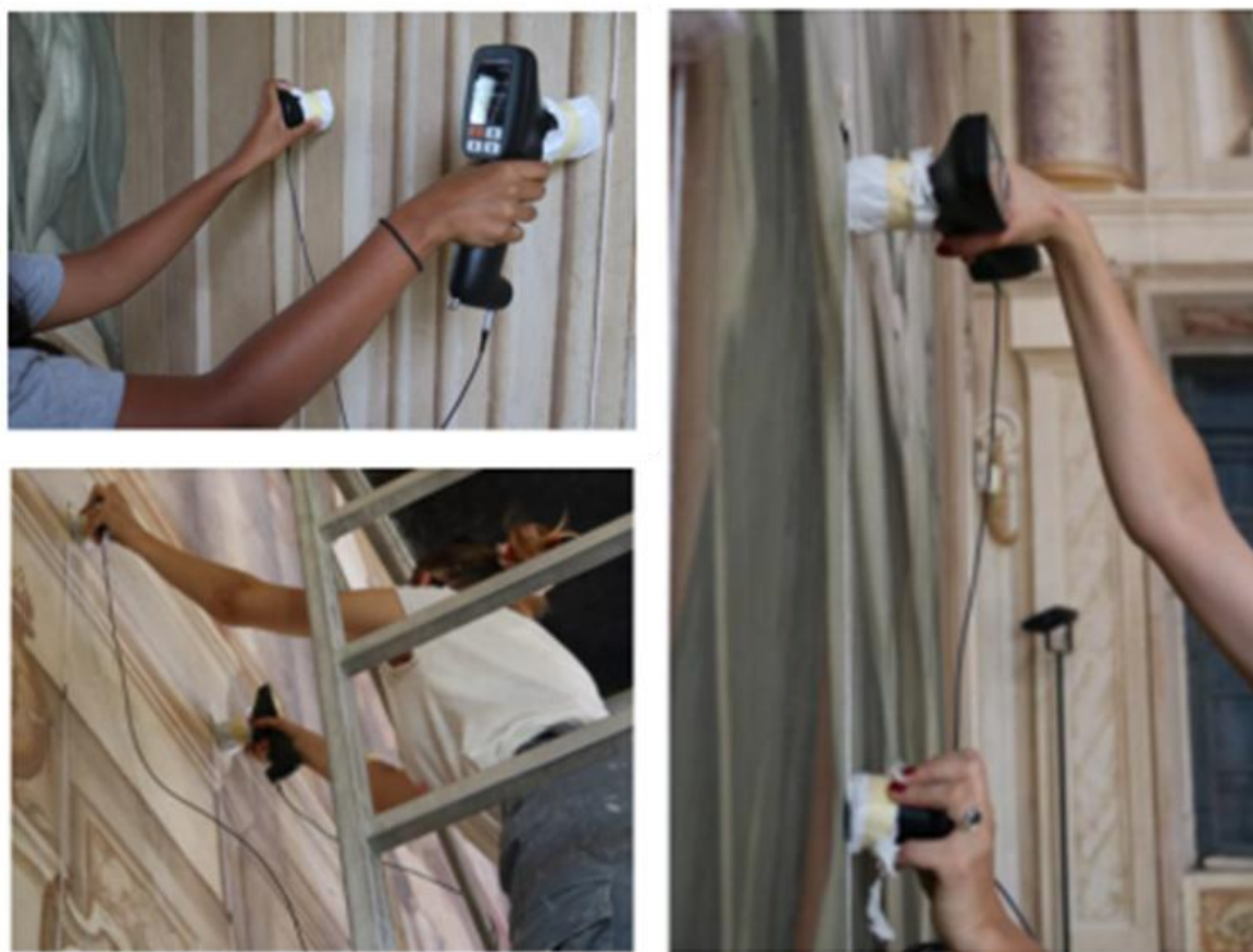
Figura 7. Esecuzione delle misure ultrasoniche in orizzontale (sinistra) e in verticale (a destra); (Dariia Pashchuk, 2022/2023; Nimasa Bamunuge Perera, 2023/2024).
