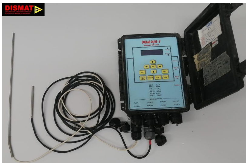
Figura 4. Sonde Termiche e centralina di acquisizione.
